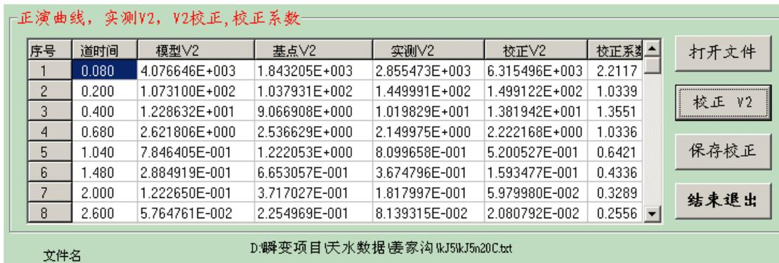
点击**打开文件**装入待校正的测点文件,点击**校正 V2**完成该测点的V2校正。如果选择了自动保存功能,则校正后自动保存为加j的文件。若取消了自动保存功能,就需要点击**保存校正**手动保存校正后的测点V2值。
